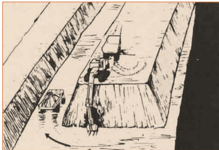
Fig. 18. - Banc de déblai pour pelle équipée en rétro-cavage.
